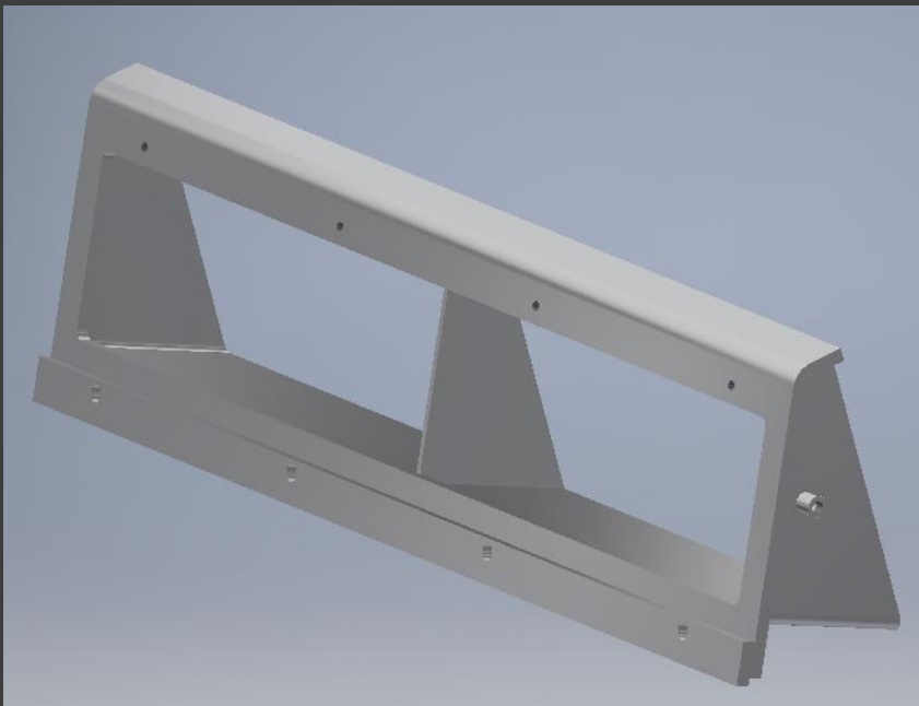
Ejemplo de brida para ser instalada en la caja de aire para sostener el limpiador
